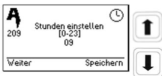
Установка часов. Запись каждой цифры должна осуществляться отдельно!
