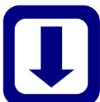
При помощи этой кнопки блоку управления передается импульс закрытия. Так как после каждого импульса закрытия сначала проверяются системы безопасности, закрытие ворот начинается после небольшой задержки по времени. Кроме того, при помощи этой кнопки в отдельных меню можно пролистывать позиции меню вниз или уменьшать значение.
