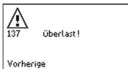
Контроллер перегружен. Проверить механизмы ворот на плавность хода. При необходимости вызвать сервисную службу.
