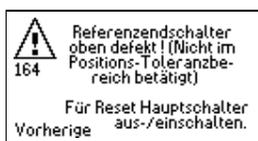
Базовый концевой выключатель для конечного положения наверху был активирован не в соответствии с действующим окном допуска датчика движения. Проверить базовый концевой выключатель, при необходимости вызвать сервисную службу.
