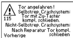
Был осуществлен наезд на ворота. Если у ворот нет функции самостоятельного ремонта, необходимо полностью закрыть ворота для квитирования ошибки. У ворот с функцией само ремонта, закрыть ворота, пока замыкающий профиль снова автоматически не зафиксируется и не достигнет нижнего конечного положения.
