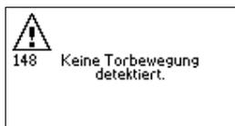
ворота заблокированы или датчик движения передает неправильные сигналы. Проверить механизмы ворот на легкость хода, при необходимости вызвать сервисную службу.
