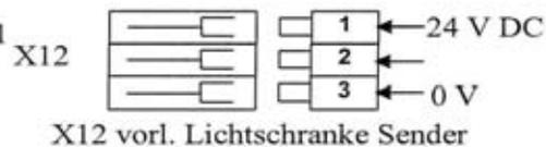
X12 передатчик подвижного фотоэлемента
