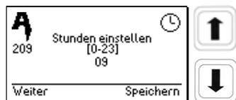
Установка часов. Запись каждой цифры должна осуществляться отдельно!
