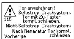
наезд на ворота. Самовосстанавливающаяся система break-away: закрыть ворота нажатием клавиши «закрыть». Не самостоятельно восстанавливающаяся система break-away: закрыть ворота после ремонта.
