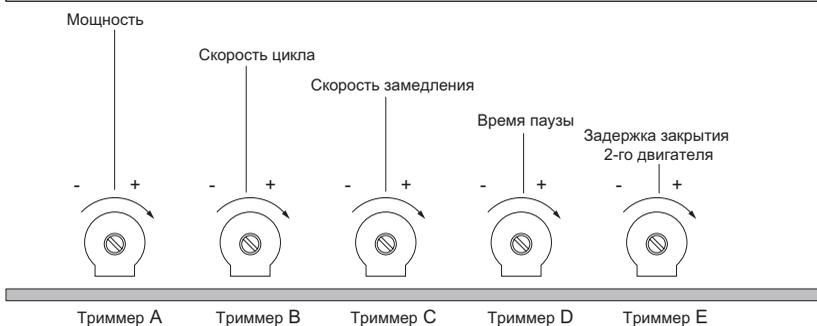
**Триммер А** (мощность): регулирует порог вмешательства электронного ограничителя мощности. Вращение против часовой стрелки увеличивает чувствительность (движение останавливается при более слабом сопротивлении); вращение по часовой стрелке снижает чувствительность и необходимо большее усилие для остановки двигателя; в этом состоянии двигатель может потреблять до 24А (576Вт) при максимальной скорости.
