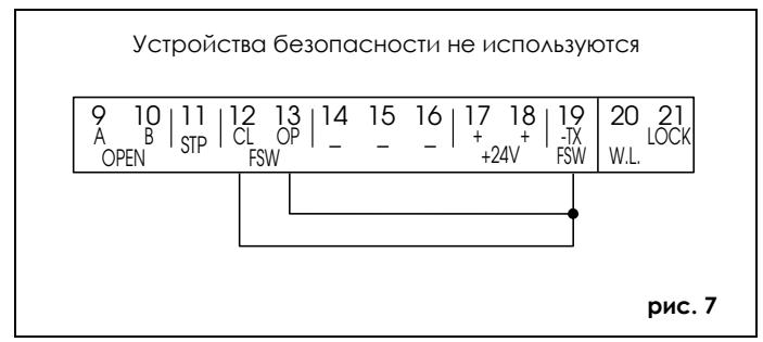
Подключение фотоэлементов защиты при открывании
