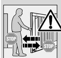
Weisen Sie alle Personen, die die Toranlage benutzen, in die ordnungsgemäße und sichere Bedienung ein. Demonstrieren und testen Sie die mechanische Entriegelung sowie den Sicherheitsrücklauf. Halten Sie dazu das Tor während des Torzulaufes mit beiden Händen an. Die Toranlage muss den Sicherheitsrücklauf einleiten.
