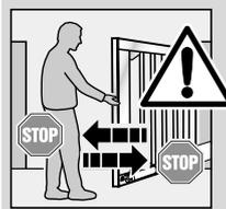
Licht alle personen die de installatie gebruiken in over de voorgeschreven en veilige bediening. Demonstreer en test de mechanische ontgrendeling en de veiligheidsterugloop. Houd daarbij het draaihek tijdens de sluiting met beide handen tegen. Hierbij wordt een veiligheidsterugloop geactiveerd.
