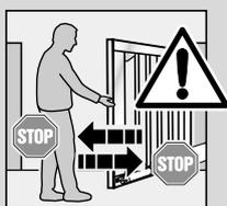
Instruya a todas las personas que utilizan la instalación de la puerta sobre su manejo correcto y seguro. Demuestre y pruebe el desbloqueo mecánico, así como el retroceso de seguridad. Para ello detenga la puerta con ambas manos durante el movimiento de cierre. La instalación de la puerta debe iniciar el retroceso de seguridad.
