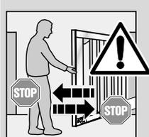
Toutes les personnes qui utilisent l'installation de portail doivent être formées à son utilisation correcte et sûre. Faites la démonstration et testez le déverrouillage mécanique ainsi que le rappel automatique de sécurité. Pour cela, arrêtez avec les deux mains le portail en cours de fermeture. L'installation de portail doit effectuer un rappel automatique de sécurité.
