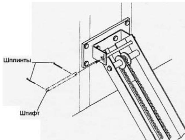
2. Переведите привод в горизонтальное положение. Медленно откройте ворота. Используя ворота как опору, выставите привод в горизонтальное положение. Установите привод параллельно центральной линии ворот. **ВНИМАНИЕ:** На рис.3 показано конечное положение привода после монтажа.
