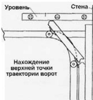
3. Используйте проведенные линии для монтажа головного кронштейна согласно рисунку. При необходимости укрепите стену в месте крепления кронштейна деревянными или металлическими накладками.
