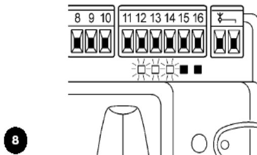
4. Если соединения правильные, СИ, связанные с НЗ контактами включены (все устройства безопасности включены), все СИ, связанные с НР входами выключены (если ФОТО2 и АУХ действуют и запрограммированы правильно СИ АУХ должен быть включен)
