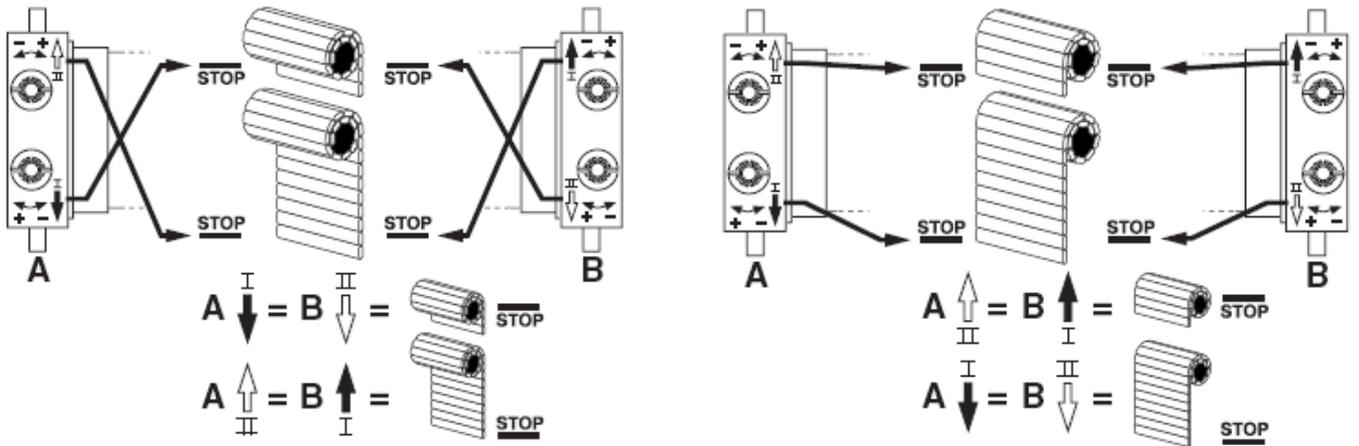
5. Подключение трёхфазного привода
