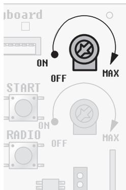
При необходимости нужное время предупреждения можно настроить с помощью потенциометра 1. По истечении этого времени предупреждение внешняя предупредительная лампа начинает мигать. При левом упоре данная функция деактивирована.
