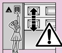
**Неподвижно установленные устройства управления (клавишиные выключатели и т. п.) должны быть смонтированы на расстоянии видимости ворот, однако, в стороне от движущихся частей ворот и на высоте не менее 1,5 м. Они должны быть обязательно смонтированы на высоте, не доступной для детей!**
